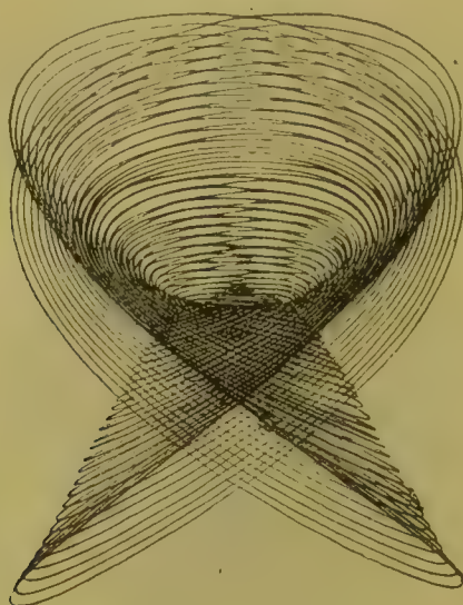
Fig. 113. \frac{2}{3} di curva tracciati dall'armonografo.
